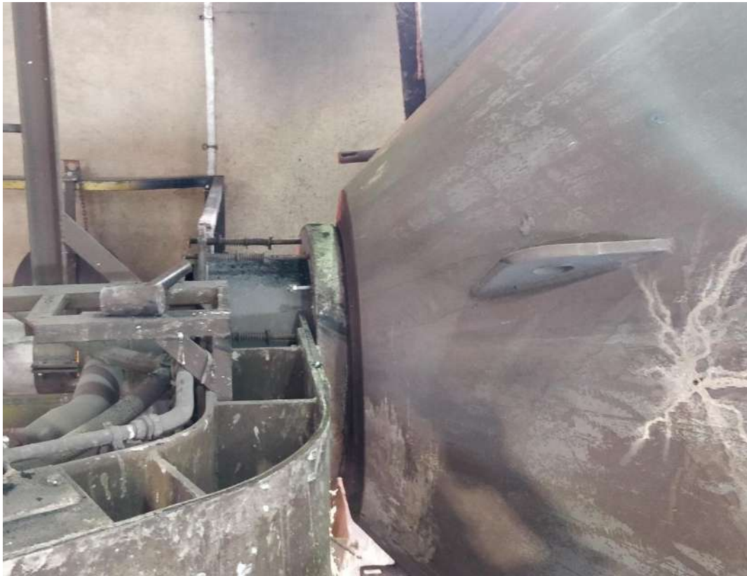
Fig. 6 – Particolare aggancio bruciatore-forno rotante
